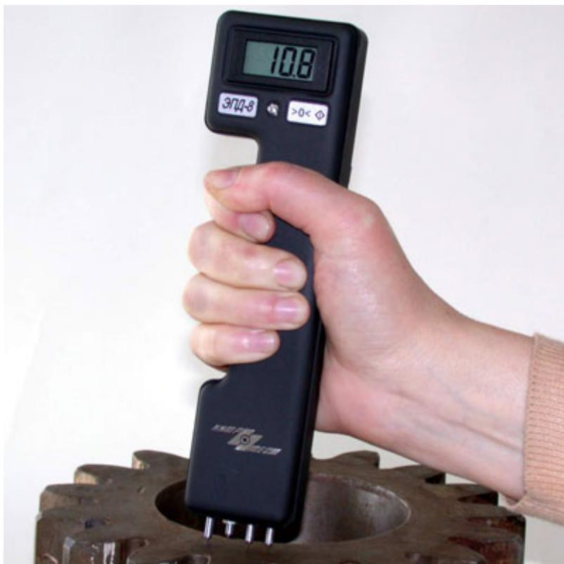
Предназначен для измерения глубины поверхностных трещин на изделиях, изготовленных из углеродистых сталей, как низко, так и высоколегированных (включая аустенитные нержавеющие). Принцип действия прибора основан на измерении падения напряжения, возникающего на краях трещины, при протекании тока по изделию в направлении, перпендикулярном трещине.
