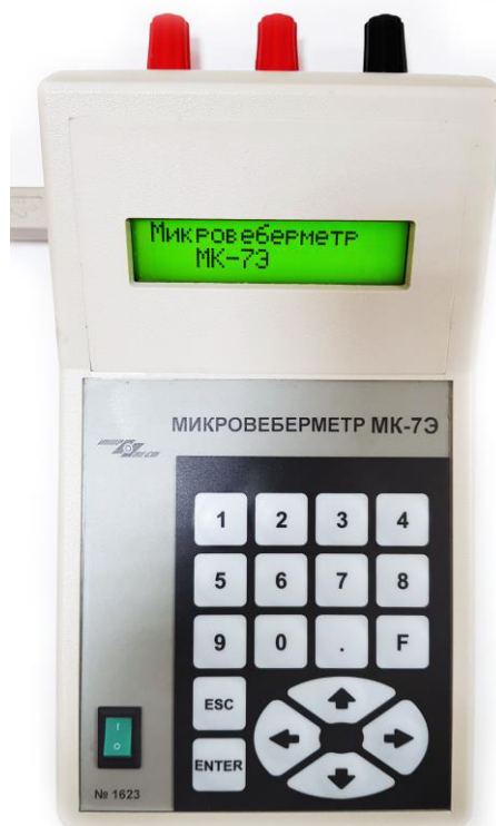
Рисунок 1 – Общий вид электронного блока микровеберметра
