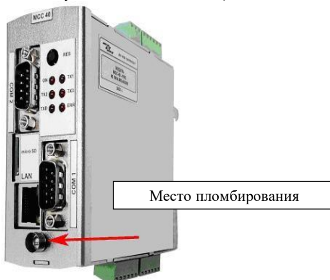
Рисунок 3 – Общий вид КТС.Х и схема пломбировки в исполнении КТС.24-02 (на базе модулей MCC 40 и MCC 08)
