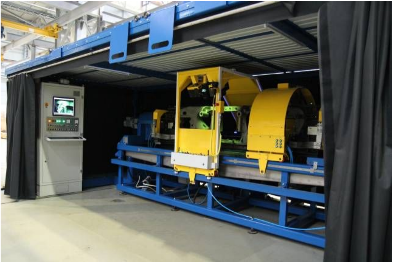
Рис. 3. Установка УМК-ЖЛ1. Общий вид. Контроль детали «Рама боковая».
