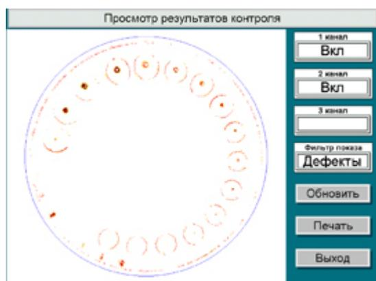
На рисунке показаны результаты контроля кассеты со стандартными образцами из титанового сплава. Стандартные образцы цилиндрической формы имеют высоту от 15 до 100 мм. В каждом образце имеется плоскостное отверстие диаметром 1,5 мм. Глубина залегания контрольных отражателей изменяется от 2 до 85 мм. Показана совмещенная развертка для двух каналов.
