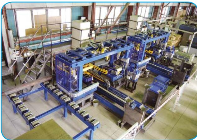
Выявление внутренних дефектов в металле заготовок железнодорожных осей в процессе производства.
